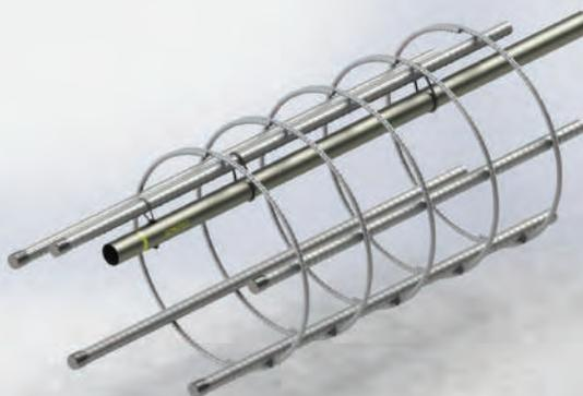
2 Instale o primeiro tubo na armadura de aço e ajuste-o numa barra amarrando um fio de aço em torno do tubo e das alças de fixação.
